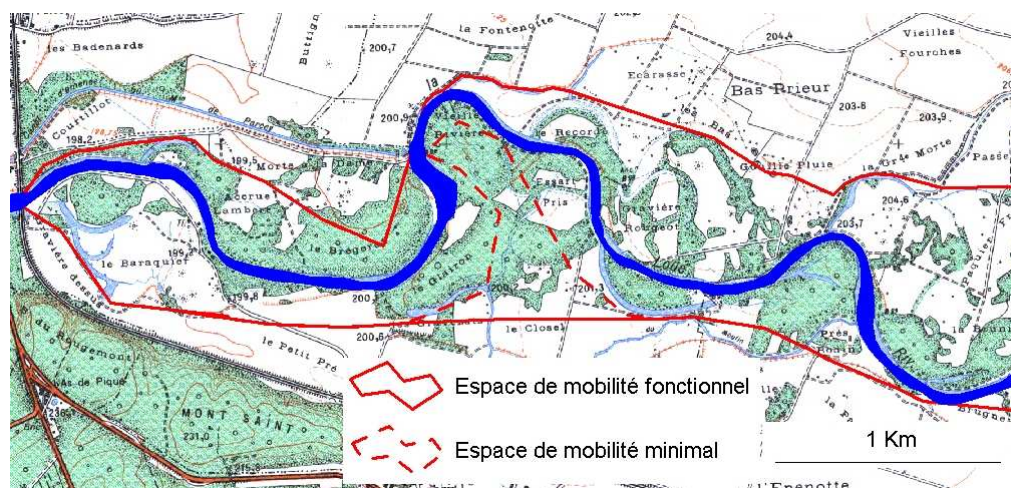
Figure 4. Vue d'une partie de l'espace de mobilité proposé sur la Loue aval (Malavoi, 2006 8 ). Les protections de berges existantes doivent être enlevées à court terme pour restaurer les processus géodynamiques naturels (érosion, dépôts...).
