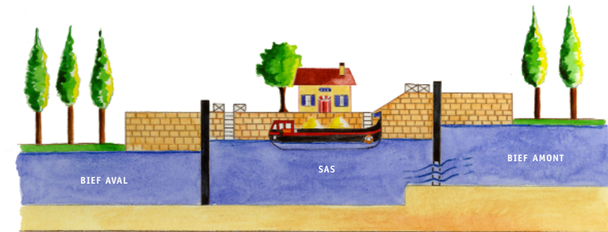
L'éclusier ferme les portes aval. Les vannes des portes amont sont ouvertes. L'eau du bief amont s'écoule dans le sas et le remplit. Le bateau monte avec le niveau de l'eau du sas.
