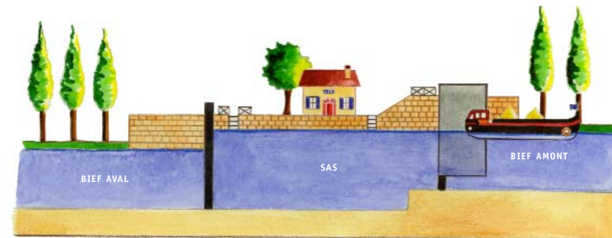
Le sas et le bief amont sont au même niveau. L'éclusier ouvre les portes amont. Le bateau sort. Cette opération s'effectue dans les deux sens de navigation.
